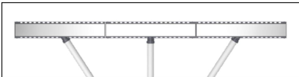
**Patas de apoyo regulables para nivelar el desagüe con respecto al piso.**
