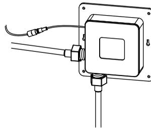
6. Coloque la junta de goma dentro de la roseta, pase el cable y el flexible por el orificio. Ajuste la tuerca.
