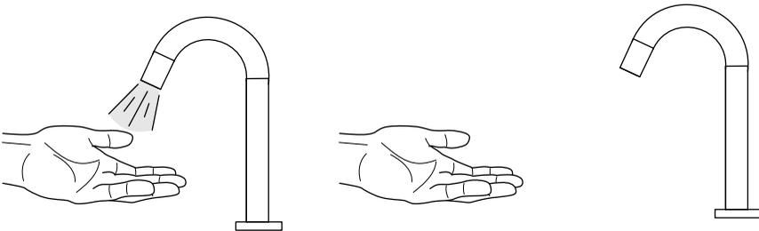
La grifería cierra automáticamente el paso de agua a los 15 segundos cuando detecta un objeto estático. Volverá a abrirse cuando las manos se encuentren en la zona de detección.
